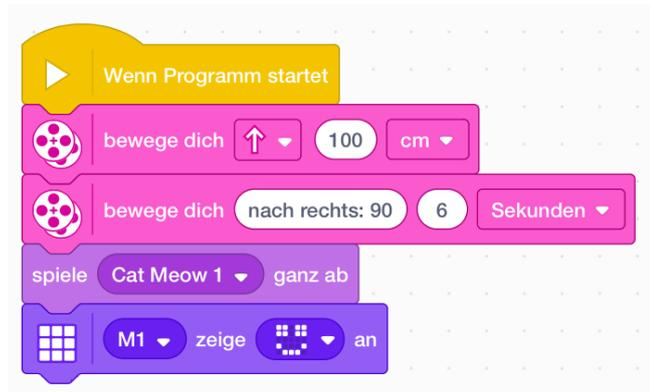
Beschreibe, wie sich der Roboter verhält, wenn dieses Programm ausgeführt wird. Eine solche Abfolge von Befehlen nennt man Sequenz.
