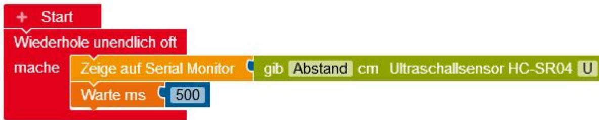
Abb. 5.1: Programmbeispiel mit Open Robert zum Ultraschallsensor
