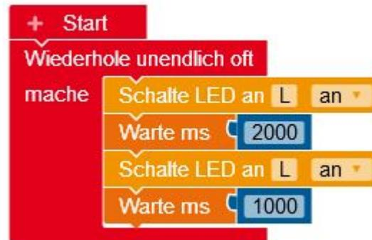
Abb. 2.5: Beispielprogrammcode für eine blinkende LED
